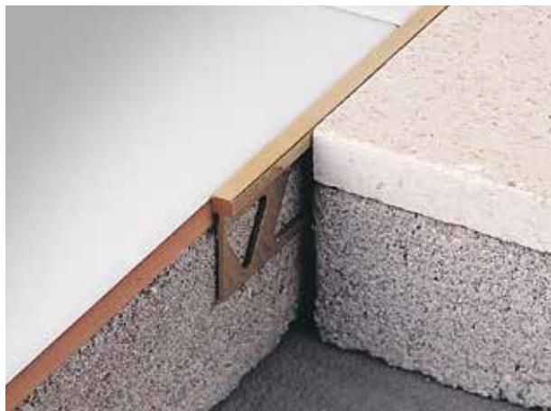
Los perfiles linetec MB se aplican simultáneamente a la colocación en mortero de los pavimentos. El ala perforada, hundida en el mortero de colocación, permite un agarre seguro del perfil entre las dos superficies adyacentes. Habitualmente utilizados en suelos de mármol, para fraccionar la superficie y realizar agradables efectos decorativos. Disponible en latón y aluminio en dos anchos de cabeza diferentes de 5 y 10 mm. Lijable en obra.
